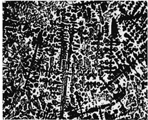
2. Structure dendritique d'un bronze coulé à 8 % d'étain. Réactif au chlorure cupro-ammoniacal. Grossissement 63.
