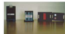
Figura 2 – Lado direito: porta-dosímetro aberto; Centro: cartão com dois detectores de \text{LiF:Mg,Ti} (TLD-100), identificado com código de barras e alta absorção; Lado esquerdo: dosímetro com etiqueta de identificação para utilização pelo trabalhador.
